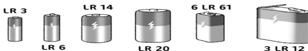
**Figure 6 :** Schéma des formats des piles.
