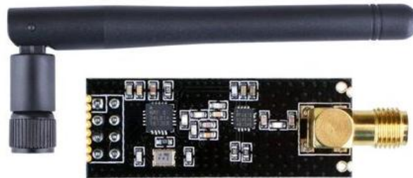
Figure III.3 : Module émetteur-récepteur sans fil nRF24L01+ PA + LNA avec antenne externe.
