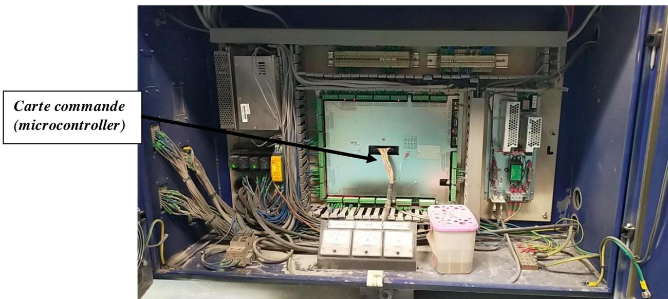
Figure III.10 : Carte de commande de presse d'injection.
