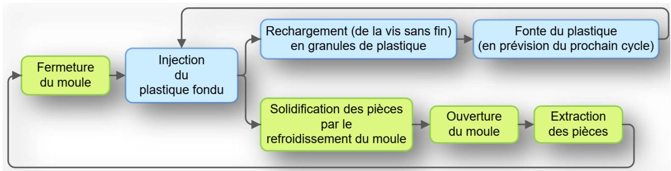
**Figure I.2:** Cycle de production d'une presse à injection de plastique.
