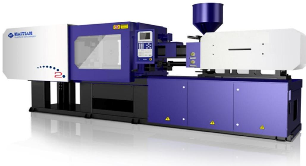
*Figure III.4* : La presse d'injection plastique *HAITIAN* de type *SA8000 II*.
