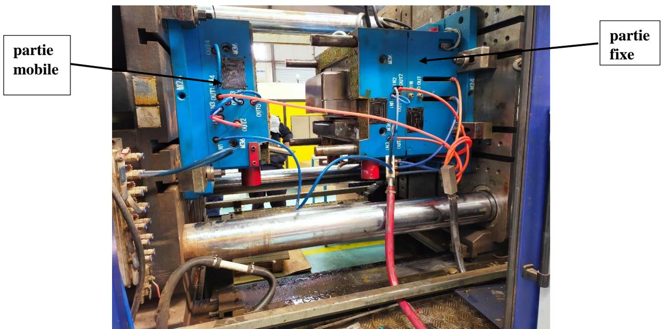
*Figure III.18* : Moule d'injection des tubes à essai
