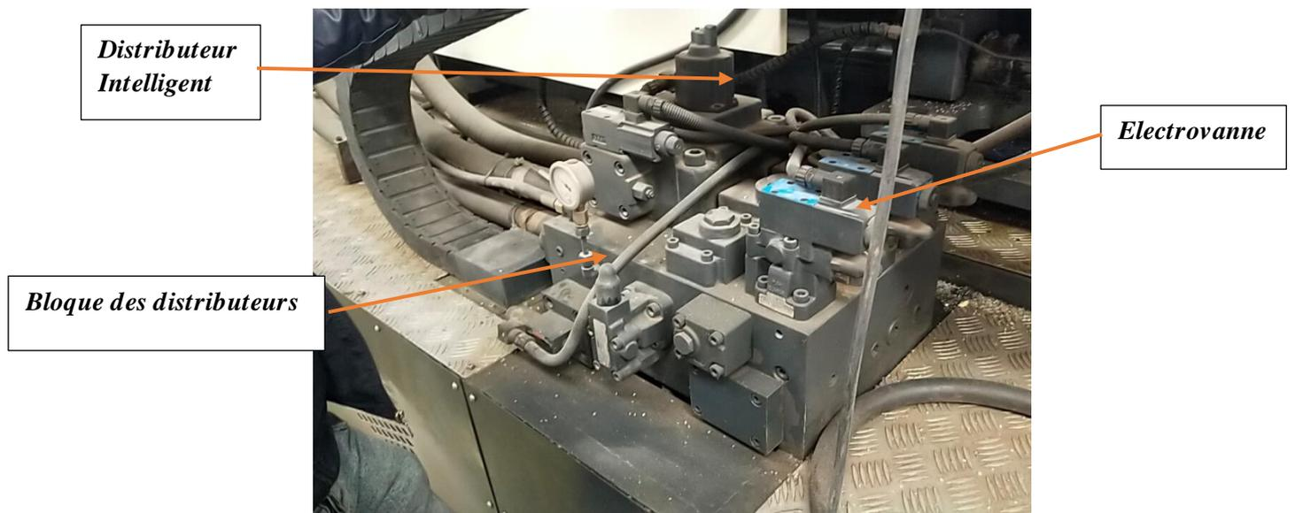
*Figure III.15 : Bloque de distributeur.*
