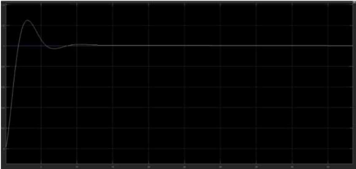
Figure III.9 la réponse échelon unitaire d'une boucle de commande avec actionneur saturation .
