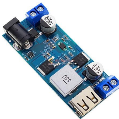
Figure II.12 : module d'alimentation abaisseur convertisseur de puissance tension [22].
