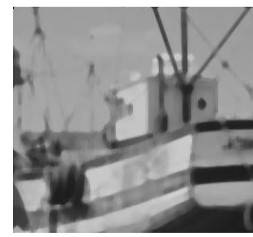
h) filtrage médian de taille (7 \times 7) psnr = 23.95dB snr = 11.01dB ssim = 0.72
