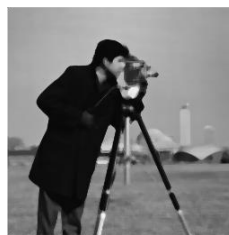
k) filtrage médian de taille (5 \times 5) psnr = 23.71dB snr = 11.56dB ssim = 0.78
