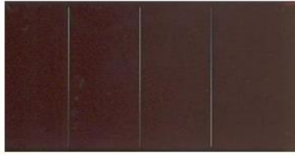
Figure I.5 : Cellule en silicium amorphe.
