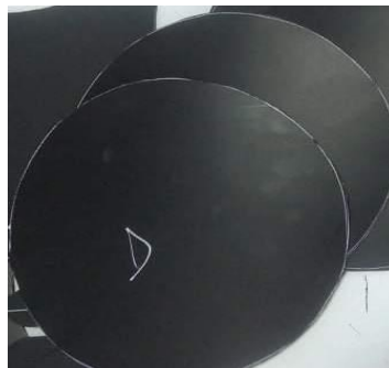
Figure III.3 : Éprouvette du test de poinçonnement PIN.
