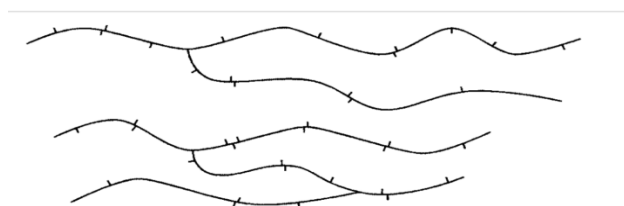
Figure II.2: Représentation schématique de polyéthylène basse densité (PEBD) [27].
