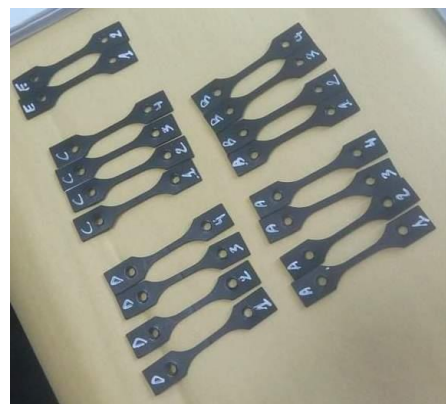
Figure III.11: Éprouvette du test de NCTL.
