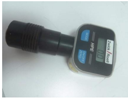
Figure III.5 : Instrument de mesure de la dureté Shore D.
