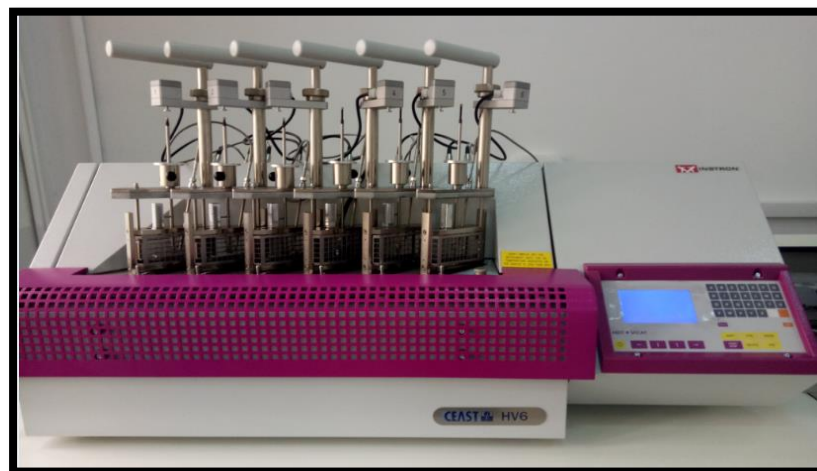
Figure III.8 : Vue d'ensemble de l'appareil de mesure HDT-VICAT.
