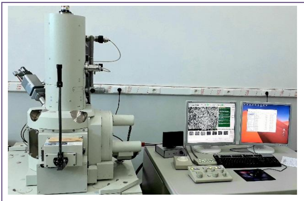
Figure II.8. Image de Micrographies au microscope électronique à balayage à émission de champ (FESEM, JEOL, JSM-6701F).
