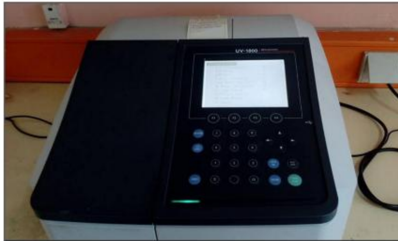
Figure II.7. Spectrophotomètre double faisceau Shimadzu UV-1800.
