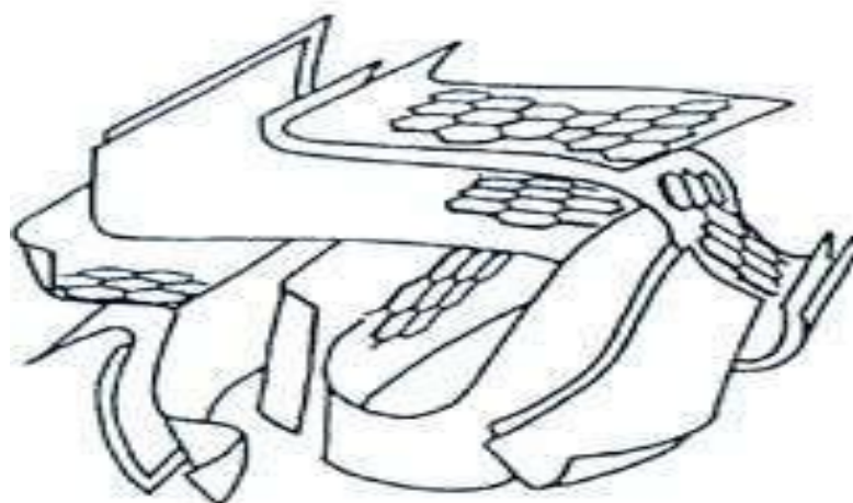
Figure III .3 : Représentation schématique des microstructures du charbon actif [10]
