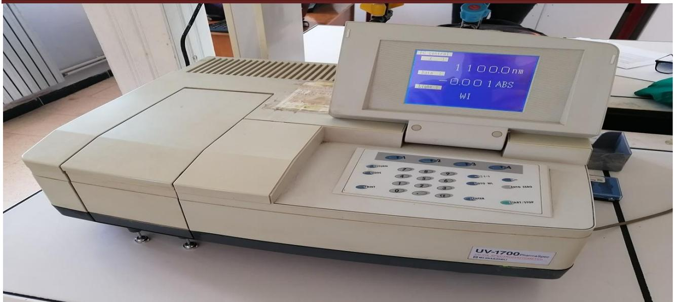
*Figure III.2 : appareil UV (Shimadzu UV-1700)*
