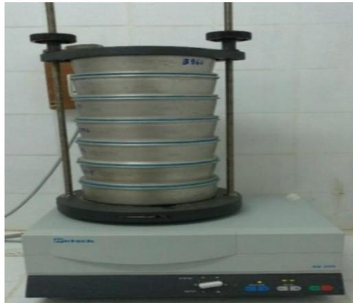
**Figure III.3.** Tamiseuse vibrante. [37].
