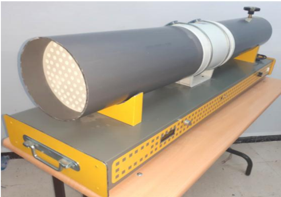
Figure II.1 : Ventilateur axial réalisé au sein de notre département.
