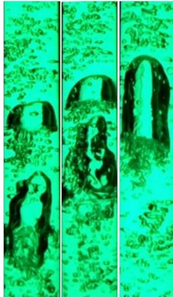
Figure 1.12 : Représentation du phénomène de coalescence des bulles.
