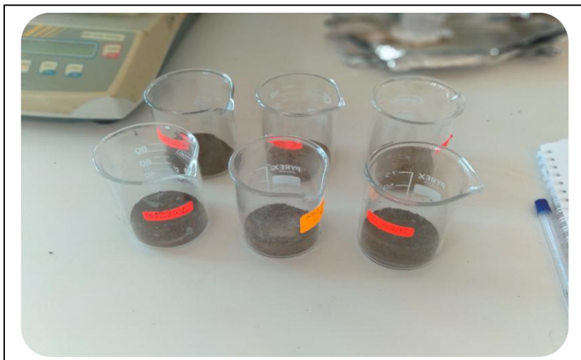
Figure 15 : Mesure de l'humidité de sol.
