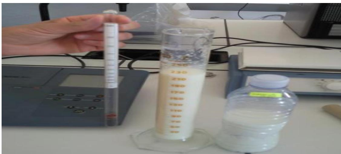
**Figure 4 :** Mesure de la densité du lait.
