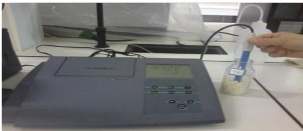
**Figure 2 :** Détermination de PH de lait par pH mètre.
