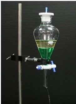
Ampoule à décanter
