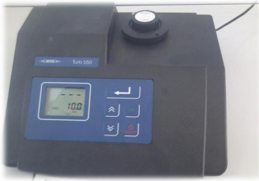
**Figure III.4:** turbidimètre.
