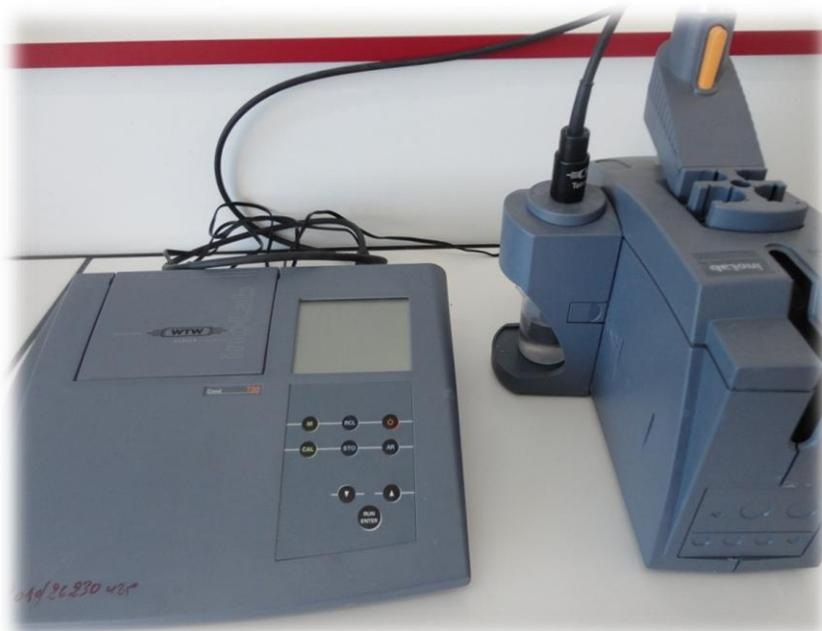
**Figure III.3:** conductimètre.
