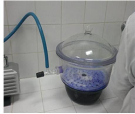
**Figure 23.** Blisters immergés dans le bleu de méthylène à l'intérieure du dessiccateur.
