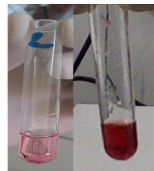
**Figure 26.** Réaction de *Trinder (GOD-PAP)* négative et positive
