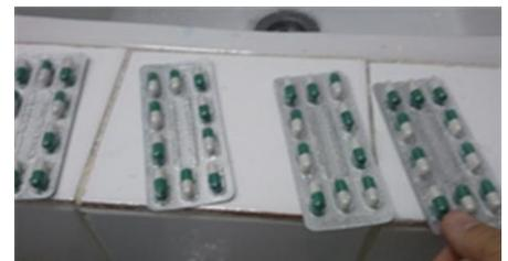
**Figure 25.** Blisters à la fin de test d'étanchéité
