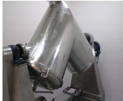
**Figure 9.** Mélangeur à tambour en V
