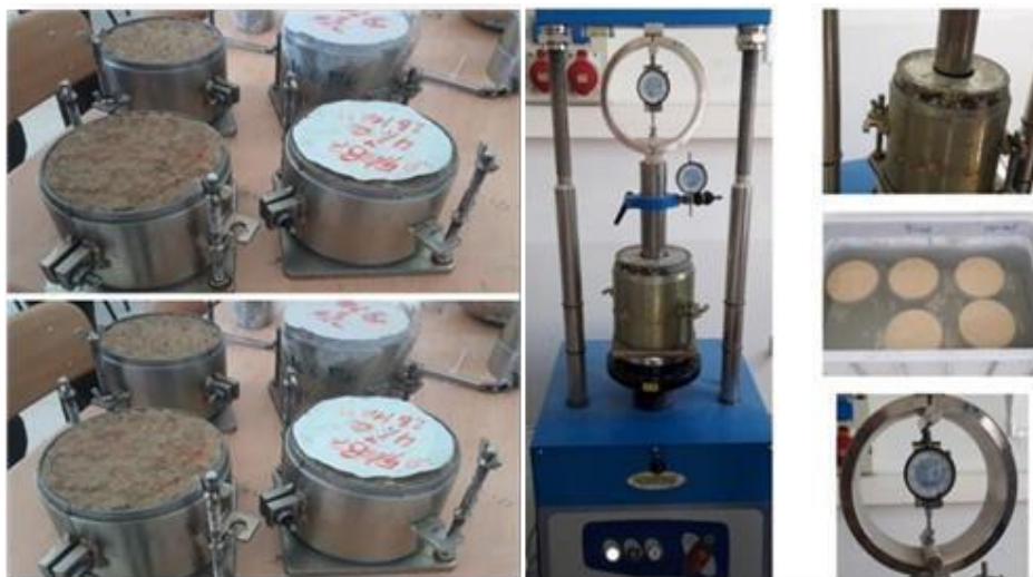
Figure III.7 Réalisation de l'essai CBR.
