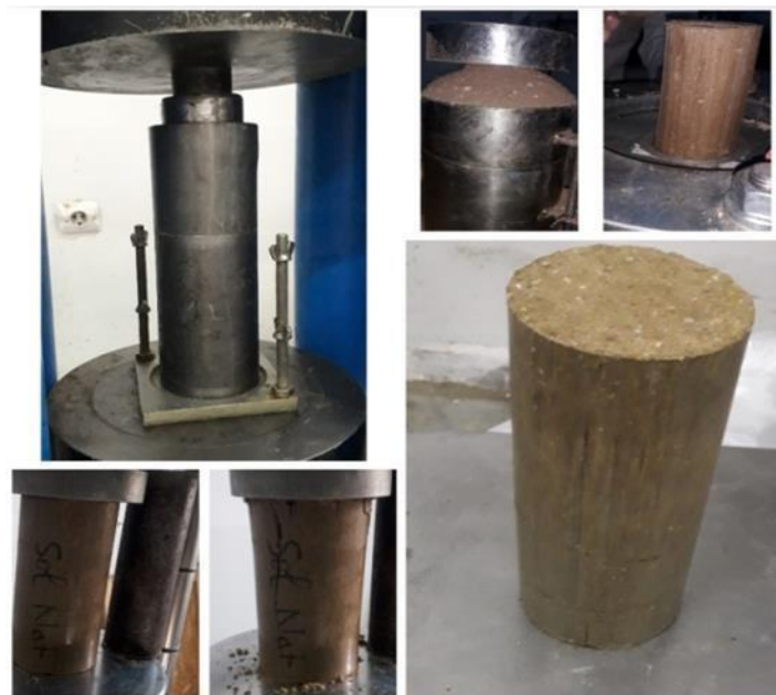
Figure III.8 Mode opératoire – Essai UCS
