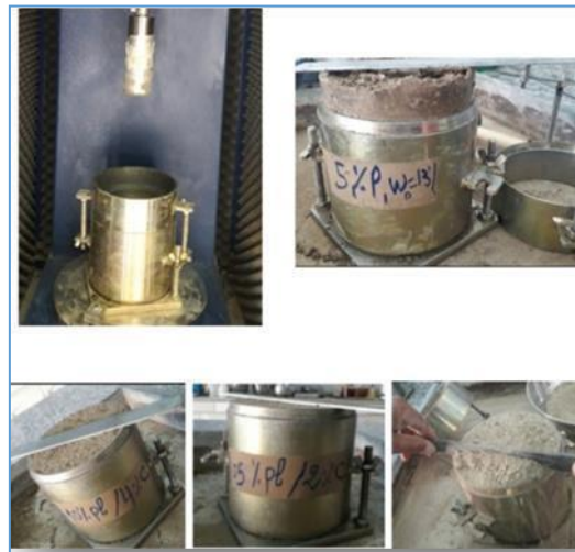
Figure III.4 . Principe de l'essai Proctor modifié.
