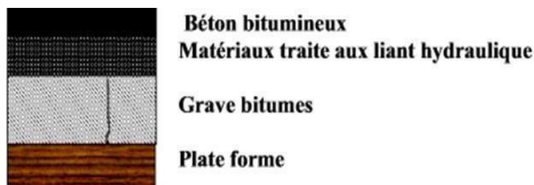
Figure II-7. Chaussées à structure mixte.
