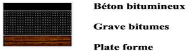
Figure II-5 .Chaussée bitumineuse épaisse.
