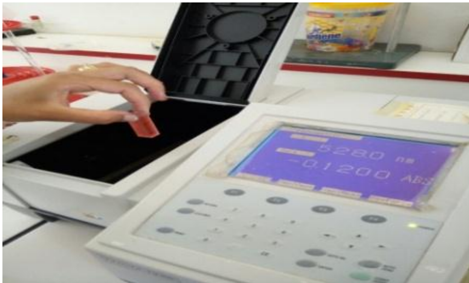
Figure 06 : Lecture sur le spectrophotomètre (TP de physiologie végétale)
