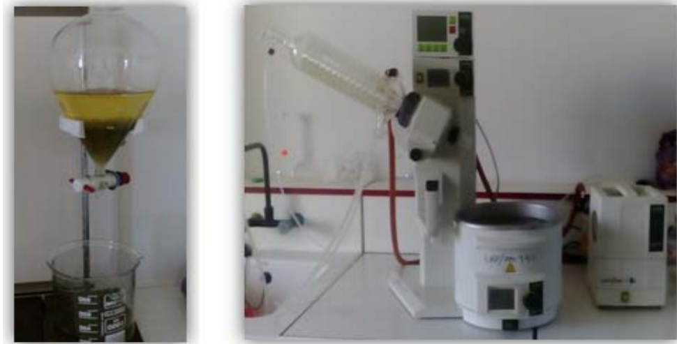
Figure .7: Représente d'un évaporateur rotatif « l'appareil d'extraction » et une ampoule à décomptation (Originale 2017).
