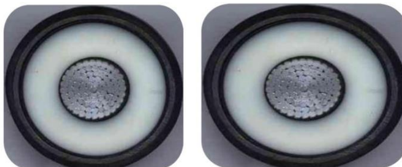
a. Câble de 225 KV d'un diamètre= 11cm b. Câble de 400 KV d'un diamètre= 13cm
