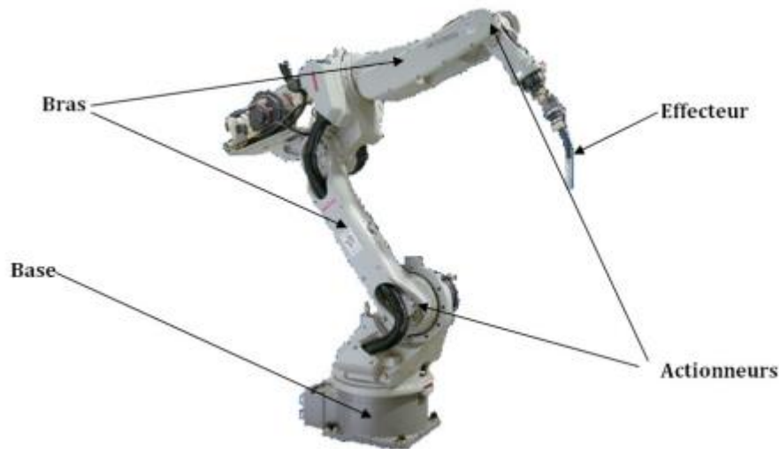
FIGURE 1.7 – structure d'un bras manipulateur [Eda01]
