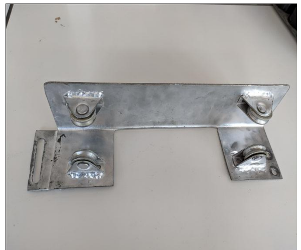
Figure III.4 guide mécanisme de système nettoyage
