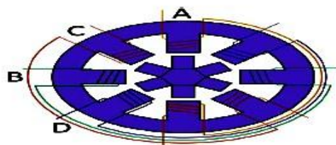
Figure II.8 Structure classique d'un moteur à reluctance [17].
