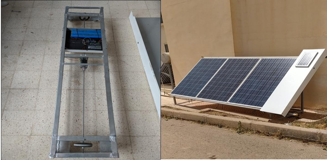
Figure III.17 assemblage conception mécanique d'un robot nettoyage PV
