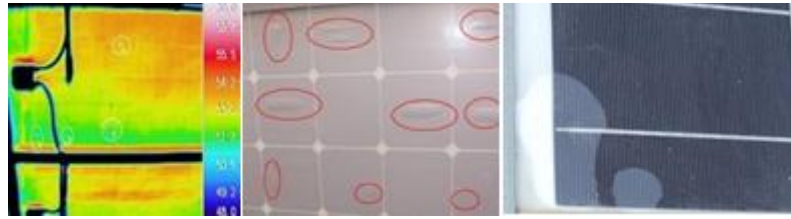
Figure I. 3 Défaut bulle d'air. [6]
