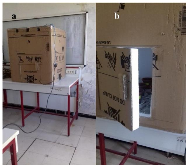
**Figure 05 :** Les boîtes isolantes du bruit extérieur (a) avec les ouvertures (b)
