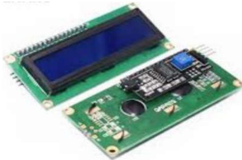
Figure III-7- Ecran LCD avec I2C
