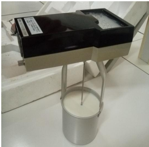
Photo1 : Mesure de viscosité par viscosimètre
