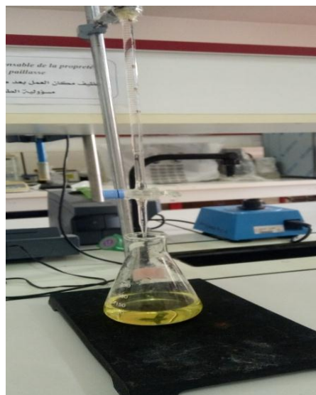
Photo 14: Le titrage pour le dosage des protéines
