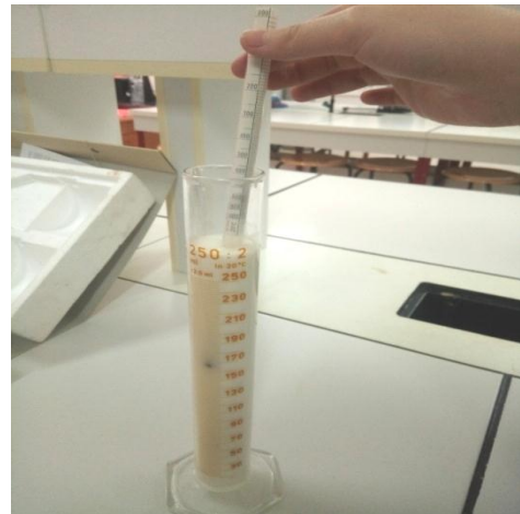
Photo 2 : Mesure de la densité du lait avec densitomètre
