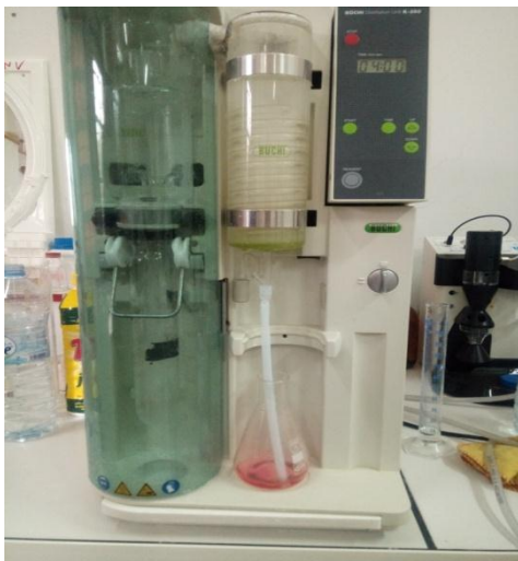
Photo 9: Le distillateur de distillation
