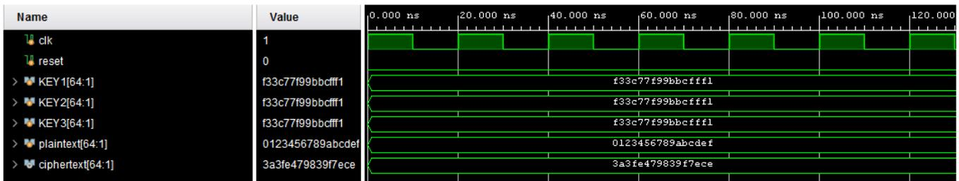
Figure.3.15. Résultat de simulation du chiffrement TDES-ECB
