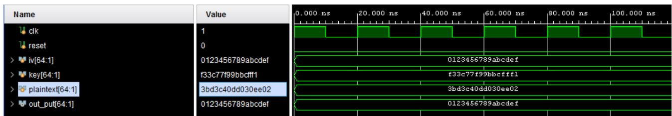
Figure.3.13. Résultat de simulation du déchiffrement DES-OFB
