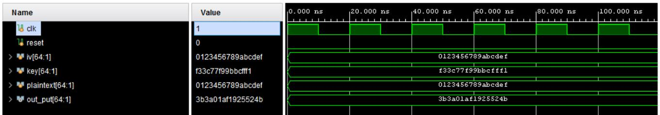
Figure.3.10. Résultat de simulation du chiffrement DES-CFB
