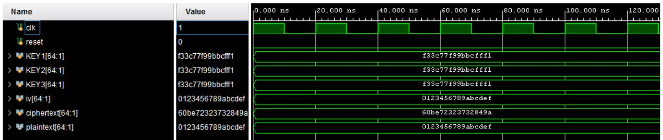
Figure.3.18. Résultat de simulation du déchiffrement TDES-CBC
