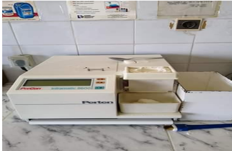
Photo 1 : l'INFRAMATIC utilisé pour obtenir le taux de protéines.
