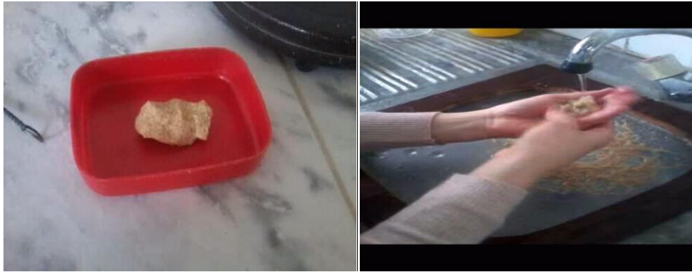
Photo 2 : Formation de pâton (à gauche) et lixiviation manuelle de l'échantillon sous un mince filet d'eau (à droite).
