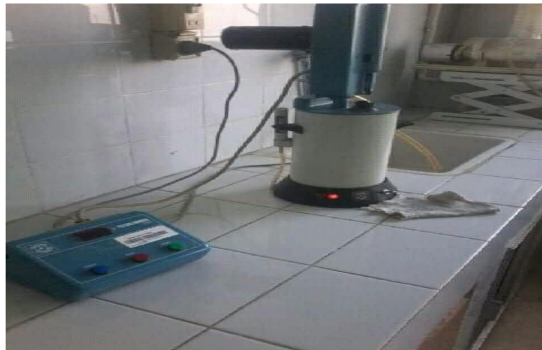
Photo 4 : Le HAGBERG utilisé pour obtenir l'indice de chute.
