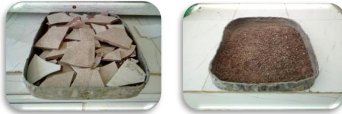
Figure 3.3 : Concassage de céramique utilisé.
