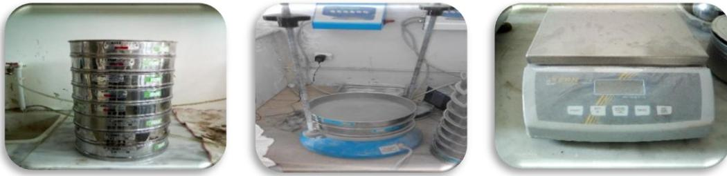
Figure 3.6 : Appareillage – essai granulométrique.
