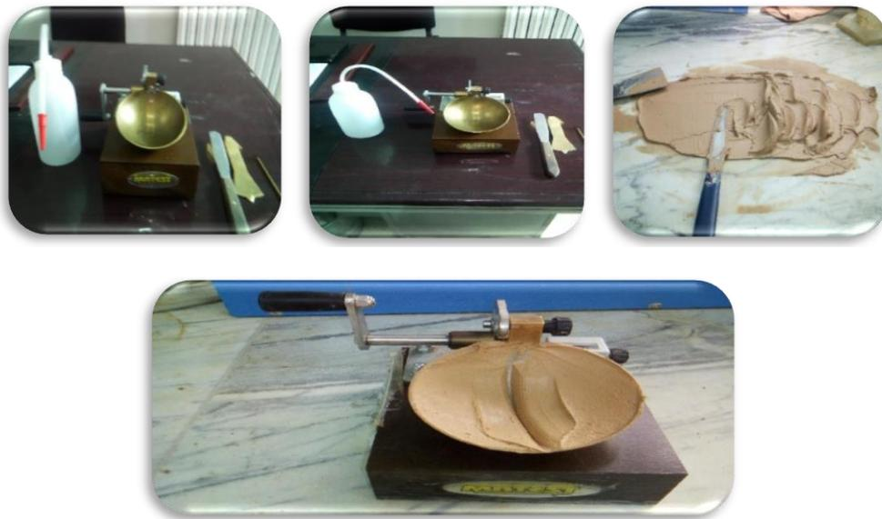
Figure 3.8 : Appareil de Casagrande.
