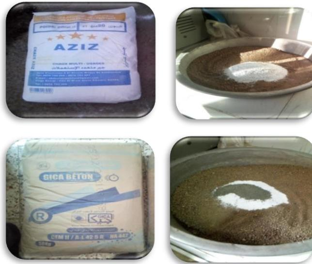
Figure 2.10 : liant hydraulique (ciment et la chaux).
