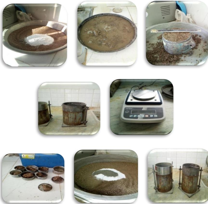
Figure 3.10 : Déroulement de l'essai – Proctor.
