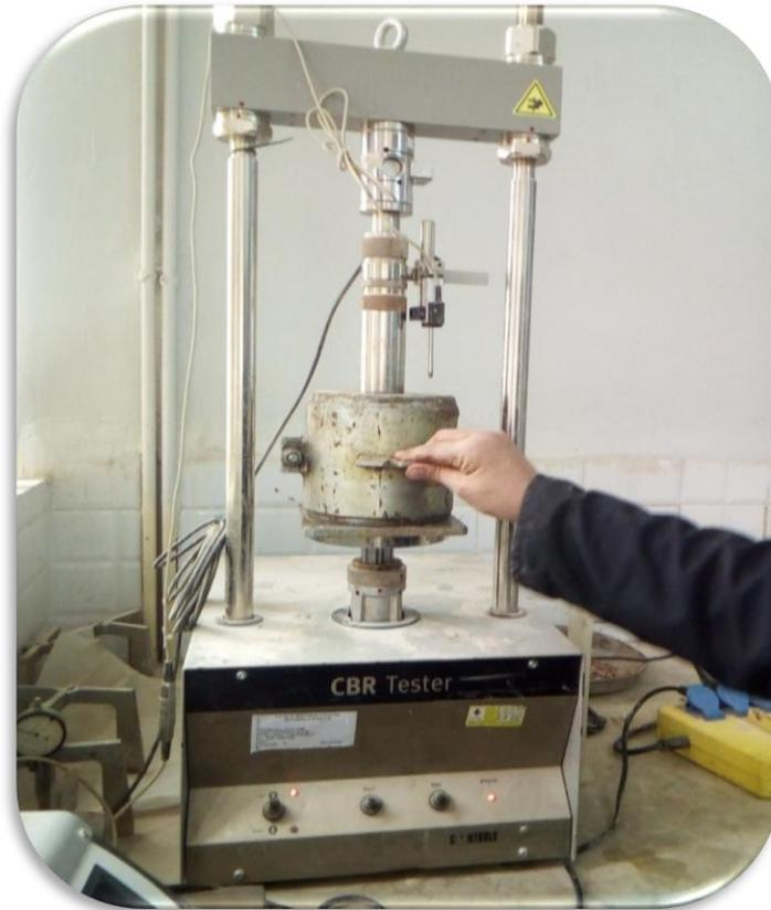
Figure 3.11 : Appareil de l'essai CBR.
