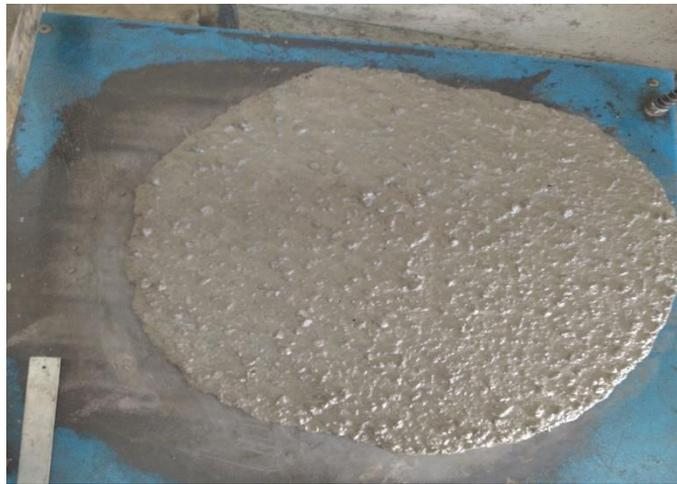
**Figure3.6** Teste de l'étalement des BAP
