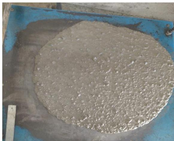
**Figure4. 1** Teste de l'étalement des BAP.
