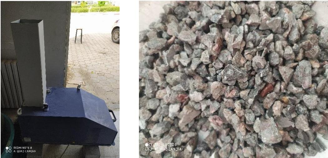
Figure3. 2 Concasseur et granulats recyclé sans traitement.
