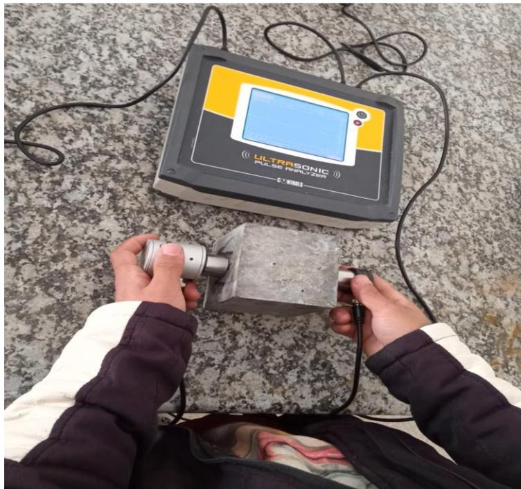
**Figure3. 5** Essai de l'ultrason.
