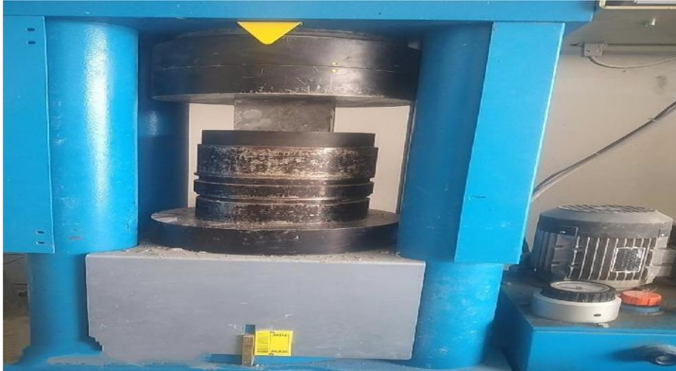
**Figure3. 4** Appareil d'essai de la résistance à la compression.
