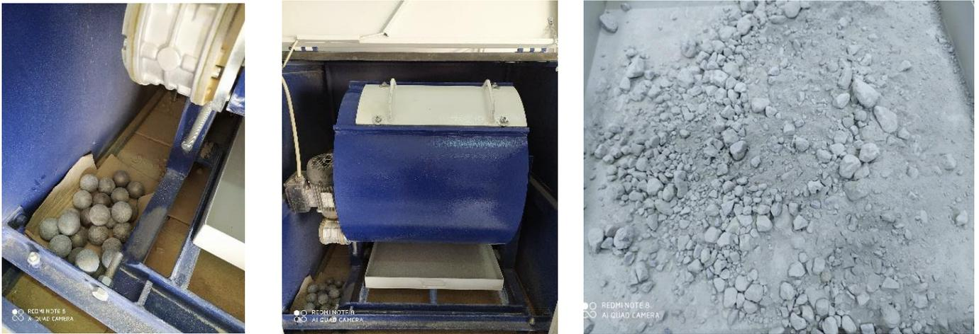
Figure 3. 3 Appareil Los angles et granulats recyclés traités.
