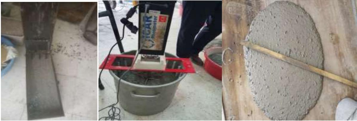
Figure 2-10 : L'ensemble des essais effectués sur le béton frais (essai de l'étalement, stabilité au tamis, boîte en L, rhéomètre)
