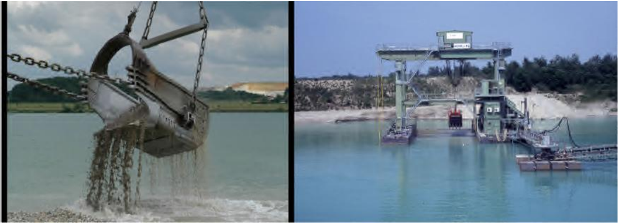
Figure 1.4 : Exploitation de granulats alluvionnaires en site immergé, (C) Excavateur à godet, (D) Drague flottante.
