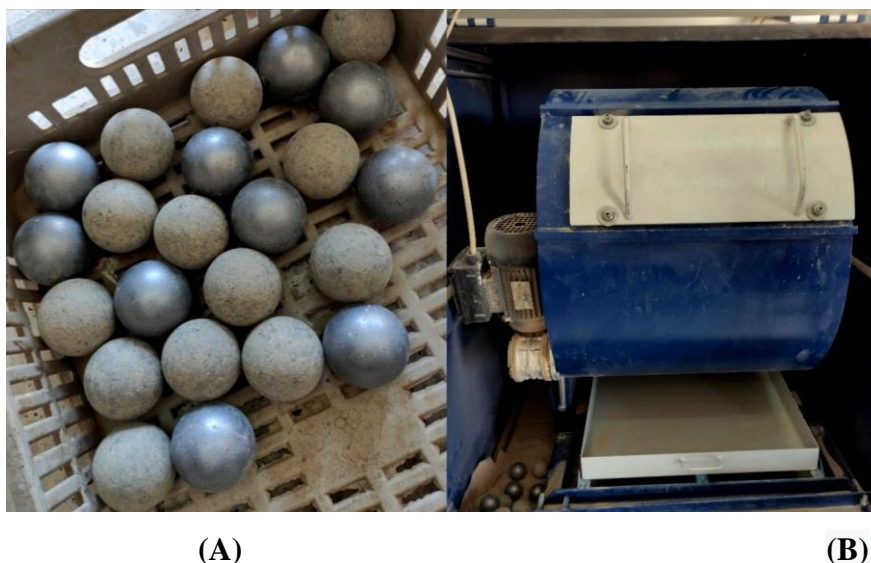
Figure III.6 : (A) : Les boulets de Los angles ,(B) : Appareil de los angles.
