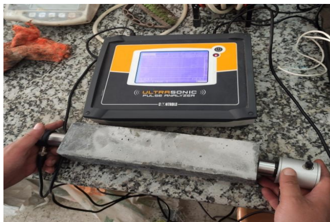
Figure IV.6 : Essai de vitesse d'ultra son.
