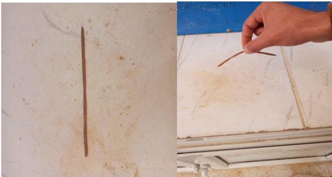
Figure 13 Détermination de la limite de plasticité : W_p
