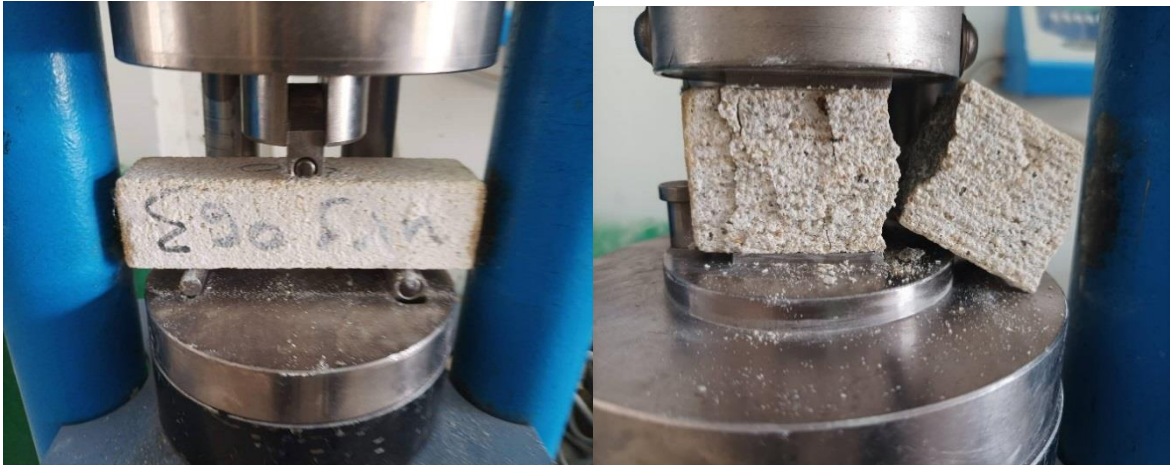
Figure 2. 4 Appareilles de l'essai de compression et de flexion.
