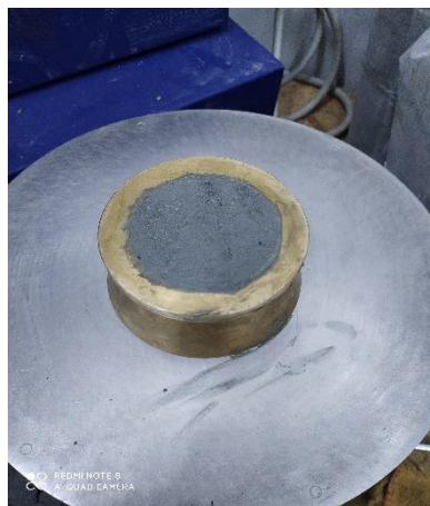
Figure 2. 3 Le test de fluidité selon la norme ASTM C 1437–20 (C1437-20, 2020).
