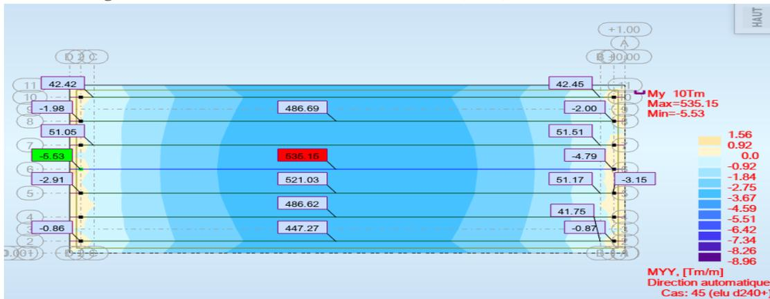
Fig. VI.13 : distribution du moment fléchissant (ELU) longitudinale sur la dalle.
