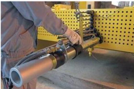
Fig.VI.09 : Vérins hydraulique
