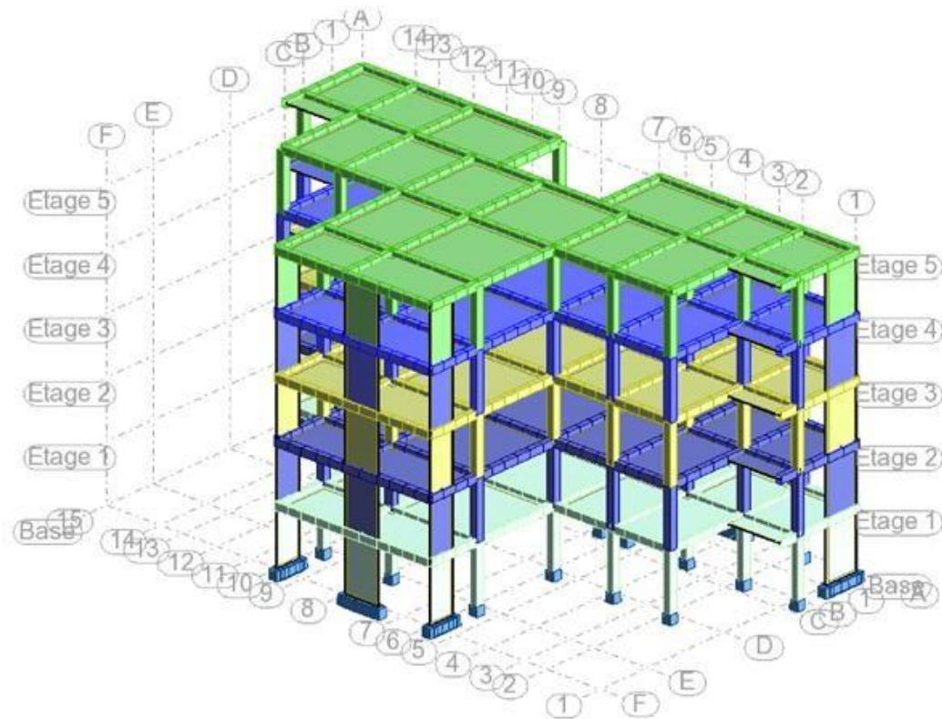
Figure 1- 1 : Structure fini sur Robot
