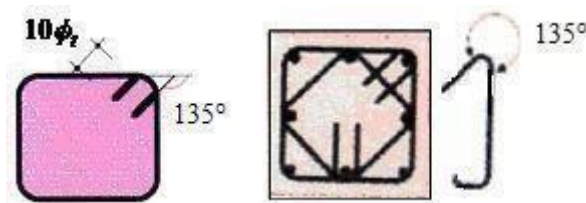
Figure V.4 : Dispositions des cadres dans les poteaux.
