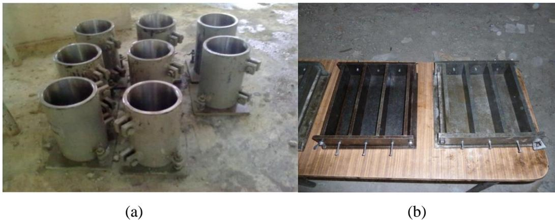
Figure III. 6 (a) éprouvettes Cylindriques 10 x20cm et (b) les éprouvettes prismatiques 7x7x28cm:
