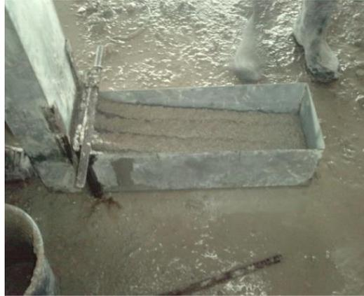
**Figure II. 4** Essai de boîte en L
