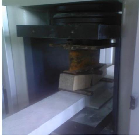
Figure II. 10 Le dispositif de l'essai de flexion 3 point.
