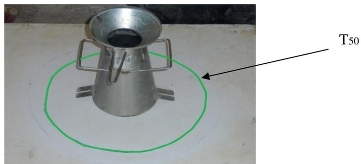
Figure II. 3 Le cône d'Abrams utilisé.
