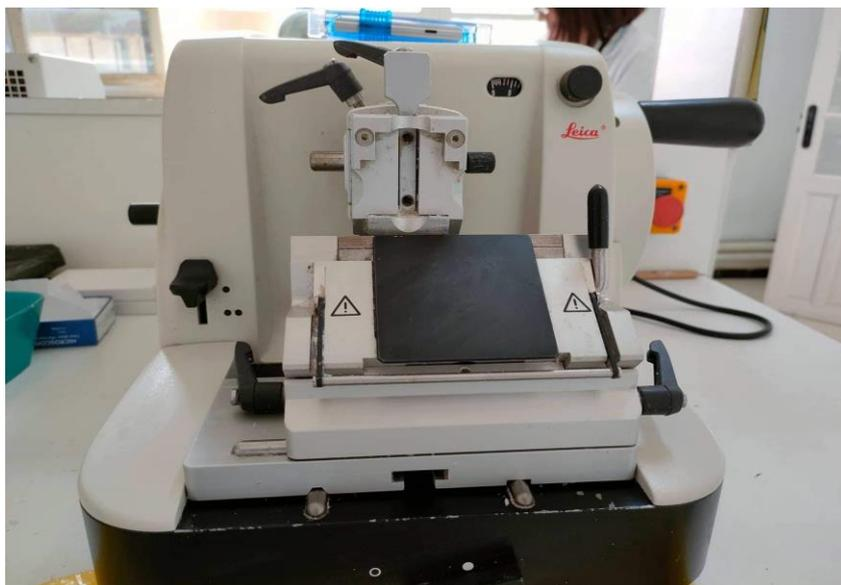
**Figure 4 :** Technique de coupe par un microtome (LEICA RM2125RT)
