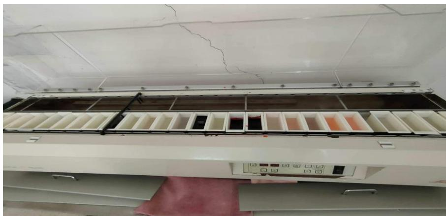
**Figure 5** : Automate pour coloration Hématoxyline-Eosine (LEICA ST 4040)
