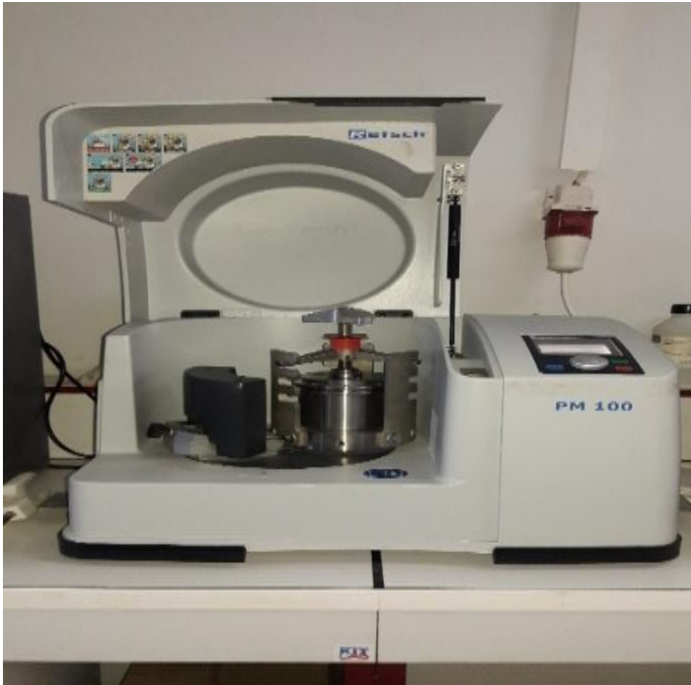
Figure II .1 : Broyeur planétaire à billes PM 100
