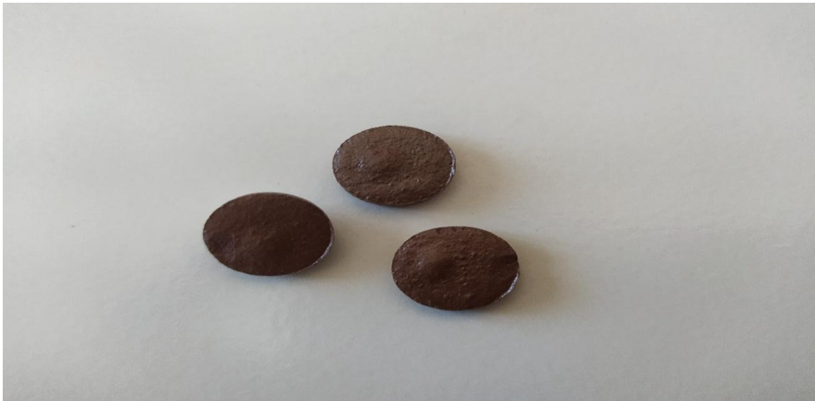
Figure III.21 : Pastilles de mélange après le frittage
