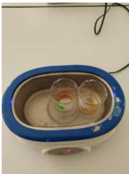
Figure 15 : photo montre deux bicher (PVA+albumine) et (PVA+PEI) dans un sonicateur
