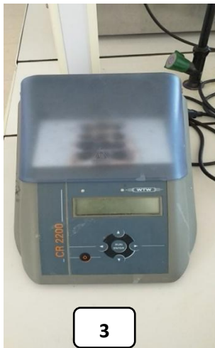
Photo 3 : Réacteur thermique préchauffé et spectrophotomètre pour la mesure de DCO
