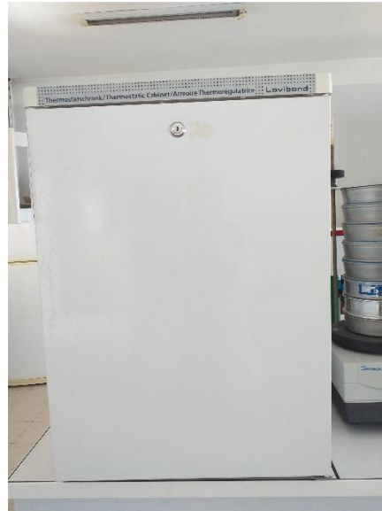
Photo 7 : Etuve réfrigérée ventilée DBO 5
