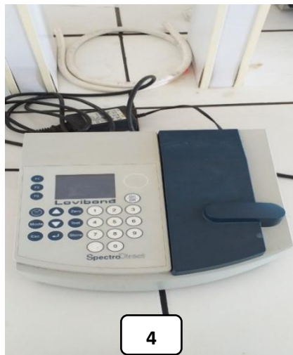
Photo 3 : Réacteur thermique préchauffé et spectrophotomètre pour la mesure de DCO
