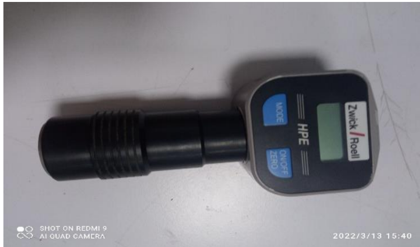
Figure III.5: Instrument de mesure de la dureté shore D.
