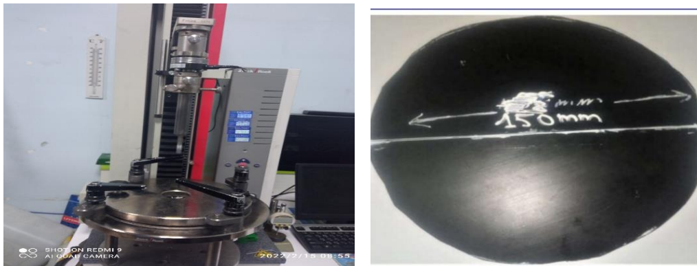
Figure III.4 : Dispositif et éprouvette de poinçonnement.
