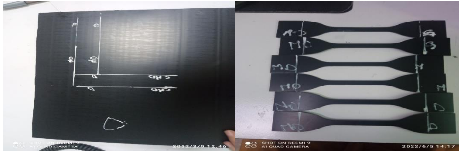
Figure III.1 : Eprouvettes de traction mécanique découpé suivant le sens machinal et transversal
