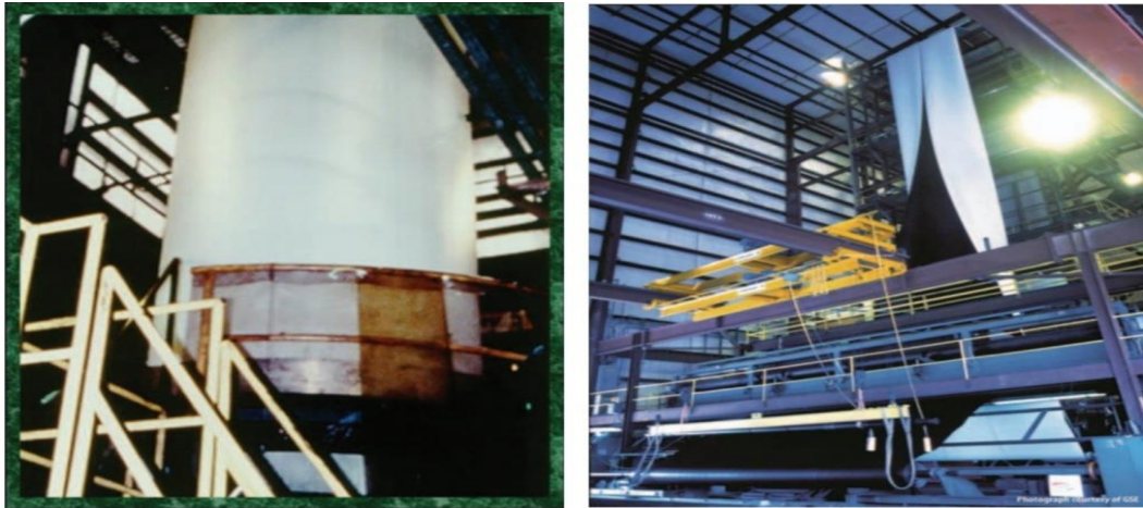
Figure II.6 : Production d'une géomembrane PEHD par la méthode de la filière circulaire [6].
