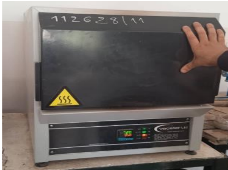
Figure III.3. Four électrique réglé à température 950 °C
