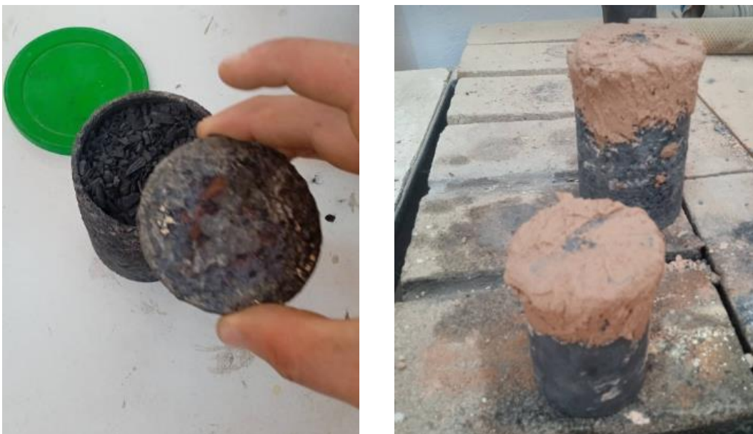
Figure III.6. Recouvrement le creuset avec l'argile
