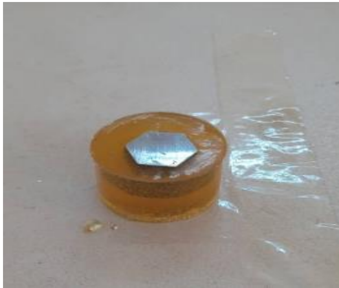
Figure III.7. Echantillon dans la résine thermodurcissable
