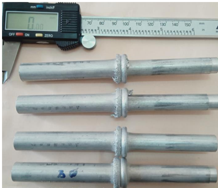
Figure 3.1 : Les échantillons soudés aluminium/aluminium juste après le soudage par friction rotative.
