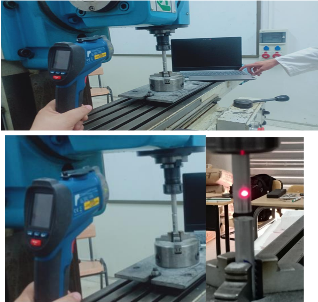
Figure 2.6 : photographie du dispositif. A) Thermocouple. B) Installation de thermocouple sur la pièce rotative.
