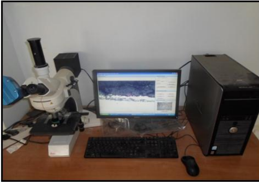
Figure III.10. Microscope optique de type LIECA DMLM.
