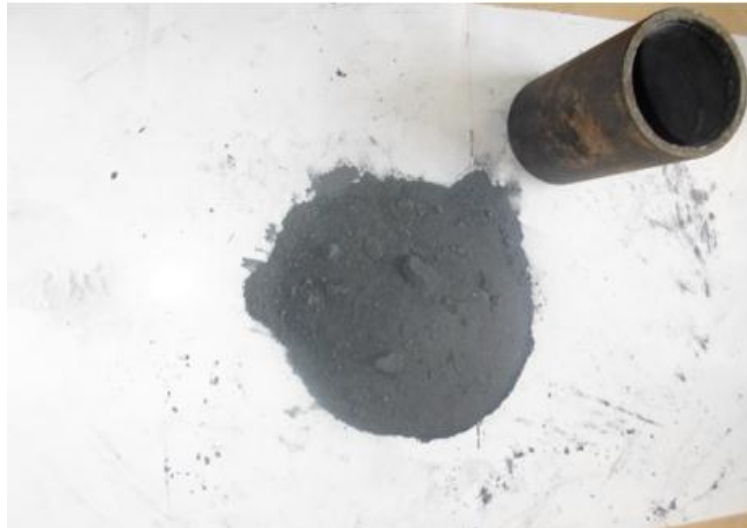
Figure III.4. Poudre de boruration- creuset cylindrique.
