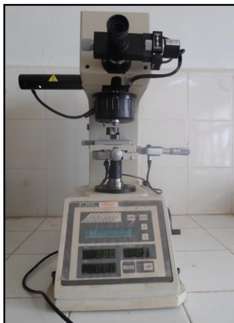
Figure III.14. Appareille de mesure de microdureté.
