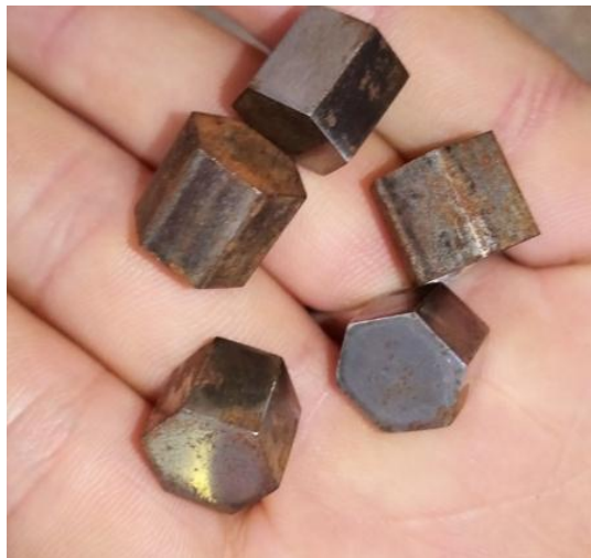
Figure III.1. Echantillons destinés au traitement de boruration.
