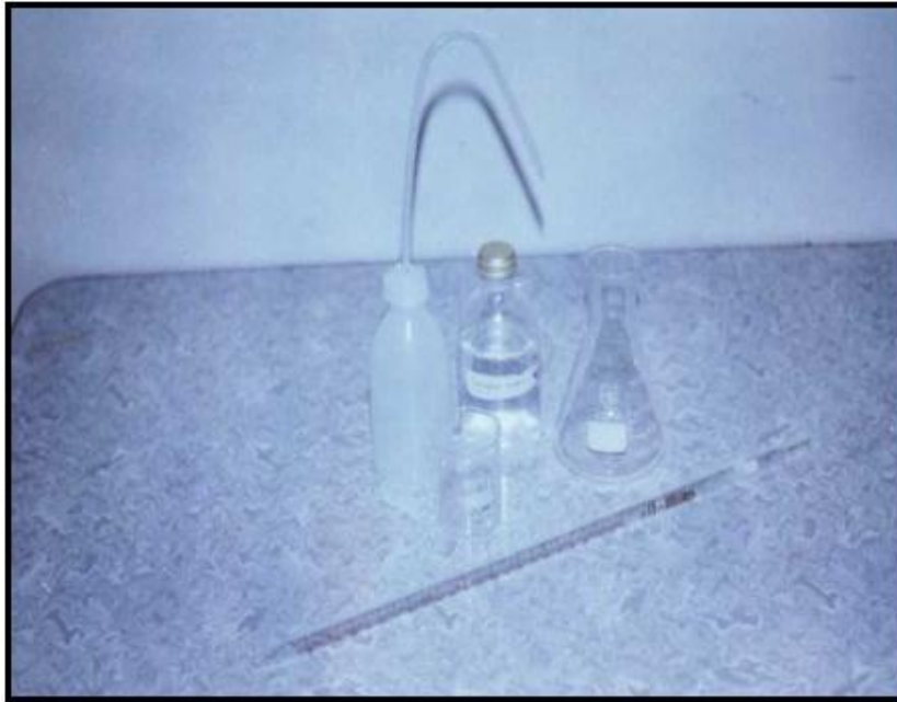
Figure III.9. Matériels utilisés pour l'attaque chimique des échantillons avant l'observation métallographique.
