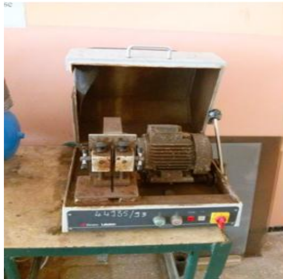
Figure III.2. Trançonneuse de découpage.
