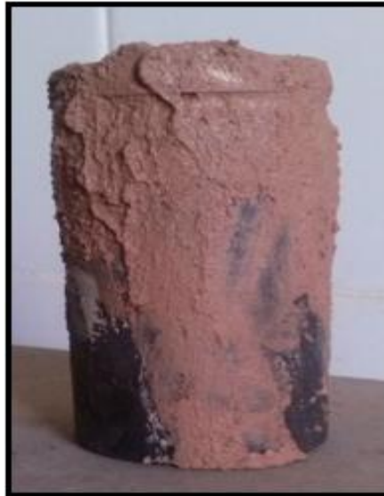
Figure III.6. Creuset préparé pour introduction dans le four.
