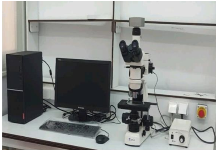
Figure II.12 : Un microscope optique de type MEIGI TECHNO MT 8500.
