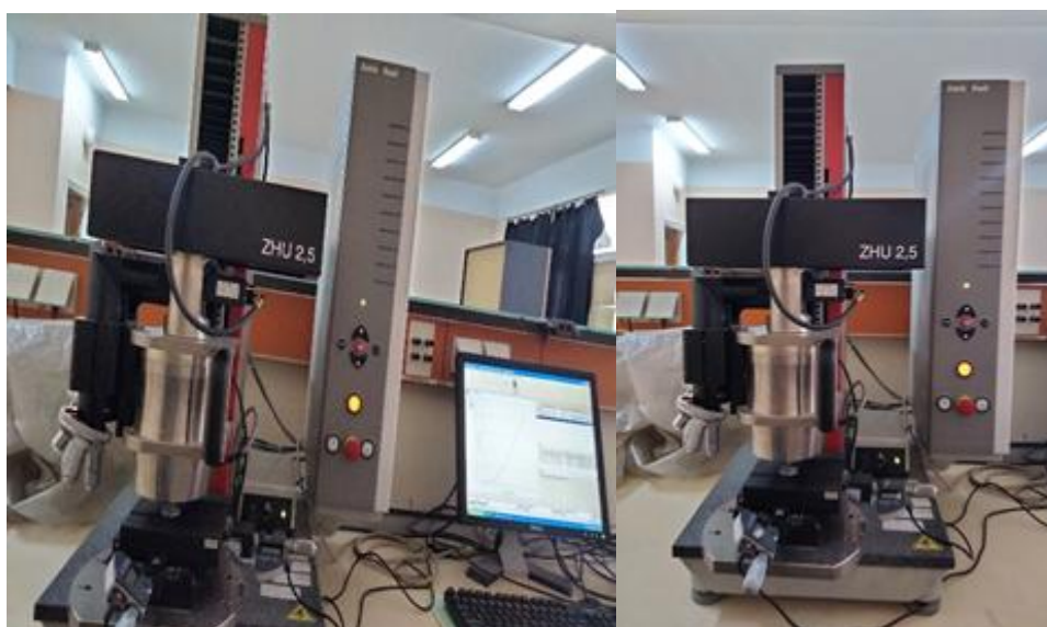
Figure II.10 :Microduromètre instrumenté de type Zwick Zhu 2.5
