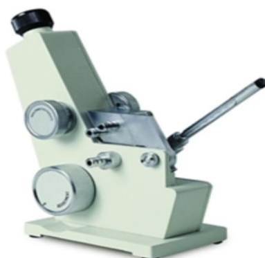
Figure II.9: Réfractomètre d'Abbé utilisé.
